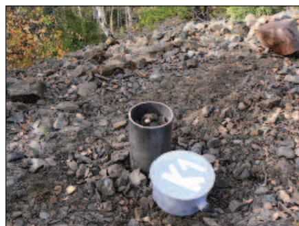
FOTO - DETAIL ZARÁŽENÉ NIVELAČNÍ ZNAČKY
